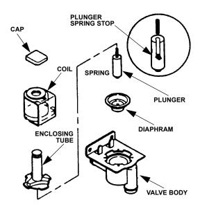
**Dump Valve Disassembly**
